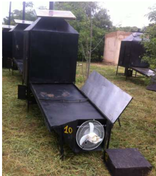
Figure 18. Séchoir mixte solaire/gaz muni d'un réflecteur (héliostat) et d'un ventilateur.
