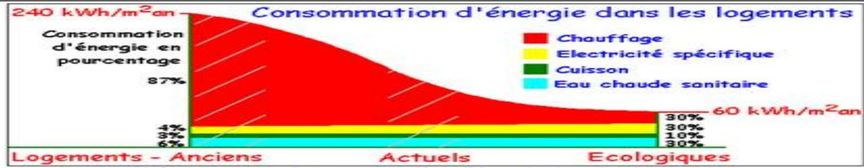
Schéma montrant la consommation d'énergie dans les logements suivant la date de construction et les choix écologiques
