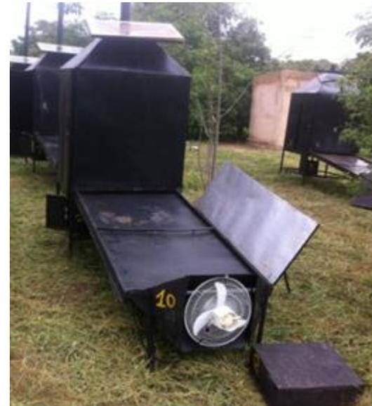
Séchoir mixte solaire/gaz muni d'un réflecteur (héliostat) et d'un ventilateur
